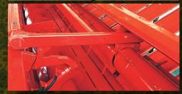
С целью достижения простой и быстрой регулировки обоих элементов аппарат резки и щиток установлены на одной платформе без какого-либо типа связи с боковинами жатки, и изменение их позиции производится на ходу из кабины комбайна с помощью компенсирующих гидравлических циллиндров. Благодаря новой системе, регулировка осуществляется одним движением.
